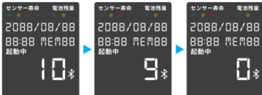
※「センサー寿命」「電池残量」の文字とランプは、起動時と残量警告時に表示されます。
