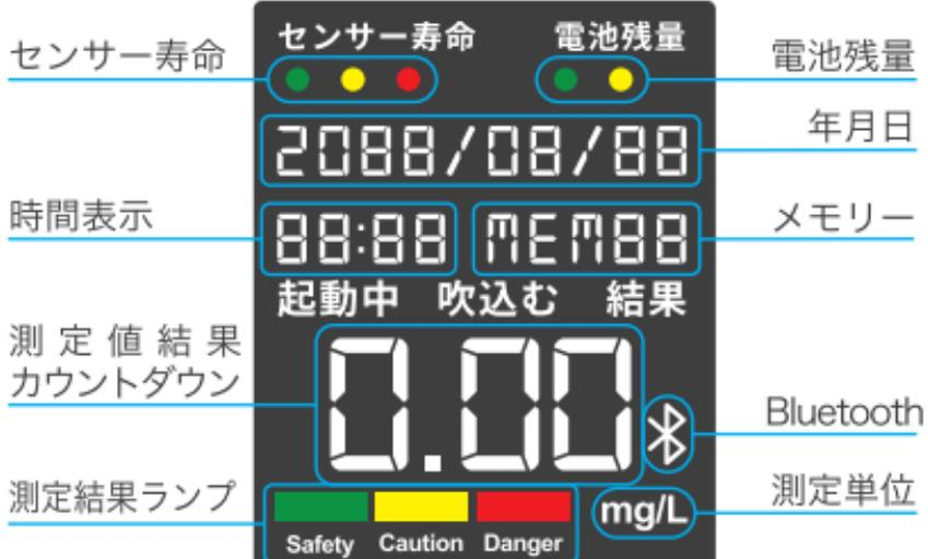
※「センサー寿命」「電池残量」の文字とランプは、起動時と残量警告時に表示されます。
